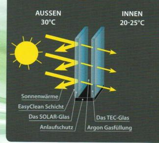
Das SOLAR-TEC®-Glas erhalten Sie in den System-Varianten: Doppelverglasung / Einkammer-Argon-Gasfüllung / U-Wert von 1,1 W/m<sup>2</sup>K Dreifachverglasung / Doppelkammer-Argon-Gasfüllungen / U-Wert von 0,6 W/m<sup>2</sup>K
